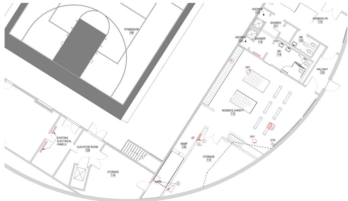
7 LOWER LEVEL ELECTRICAL FLOOR PLAN
